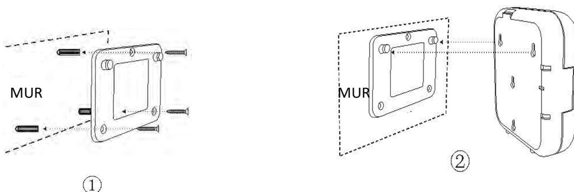
Fixer les 3 vis dans le mur avec le support de fixation murale
