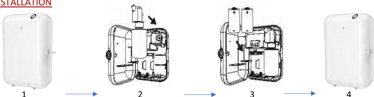
1. Insérer la clé, la tourner sur OPEN pour ouvrir et retirer la clé. Appuyer sur le bouton d'ouverture pour ouvrir.
